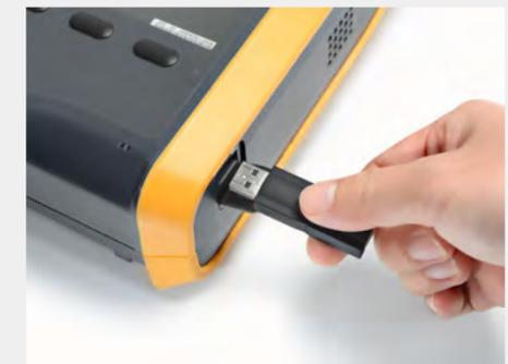
Se pueden exportar datos del D1 a través de un puerto USB y revisarlos en una PC mediante el software Mindray.
